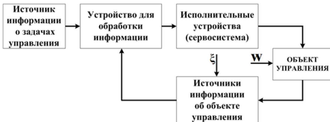
Рис. 1. Обобщенная структура САУ W — вектор возмущений, \xi — вектор помех
