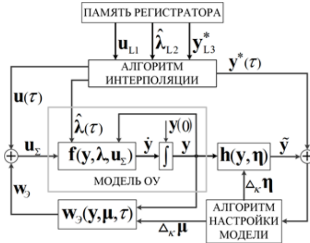
Рис. 6. Структура системы этапа 1 MAO состояния ОУ
