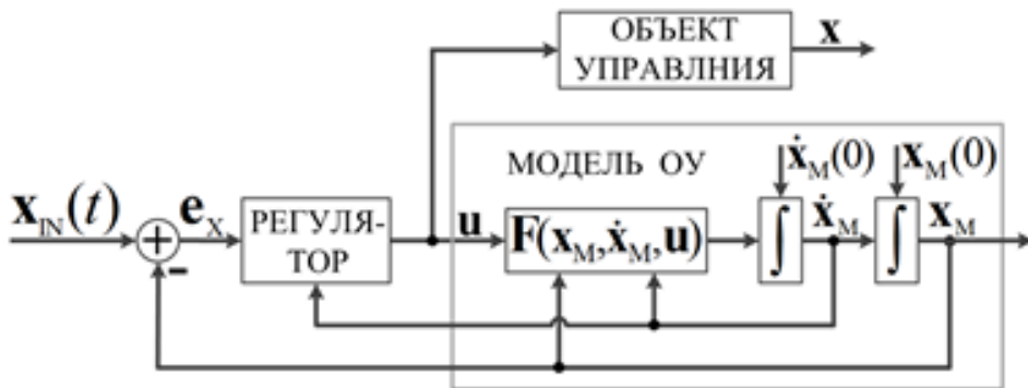
Рис. 4. Функциональная структура САУ с моделью ОУ второго порядка
