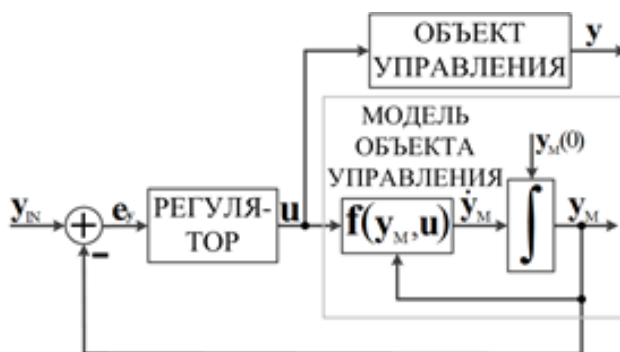
Рис. 3. Функциональная структура САУ с моделью ОУ
