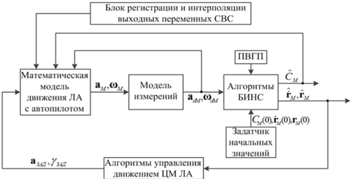
Рис. 11. Функциональная блок-схема идентифицированной имитационной модели САУ
