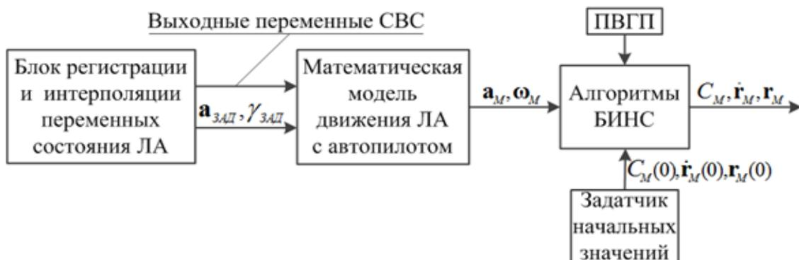
Рис. 9. Функциональная блок-схема системы оценивания входных и выходных переменных БИНС в режиме МАО
