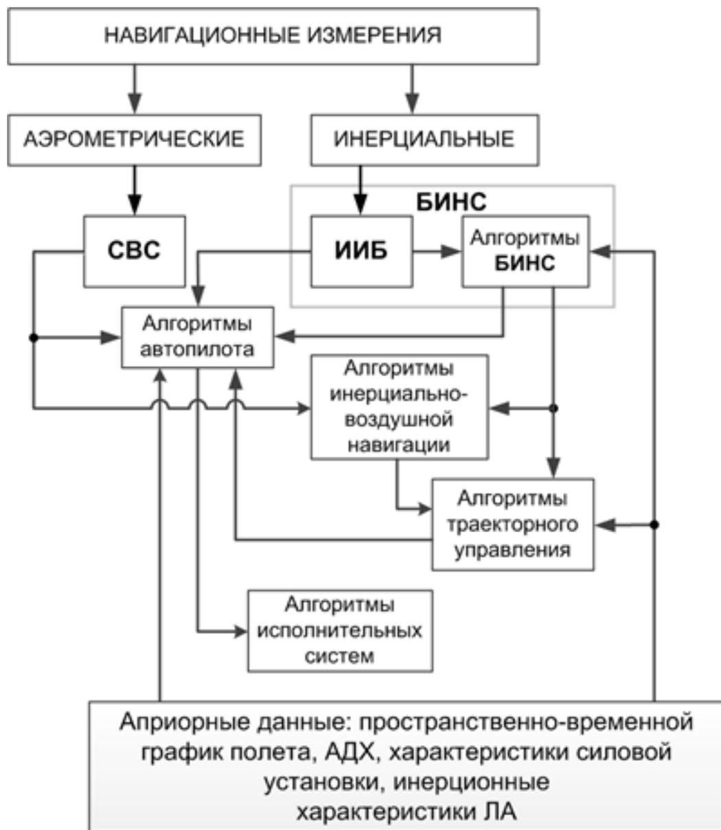
Рис. 6. Информационно-алгоритмическая блок-схема ИАИУС в режиме нормального функционирования
