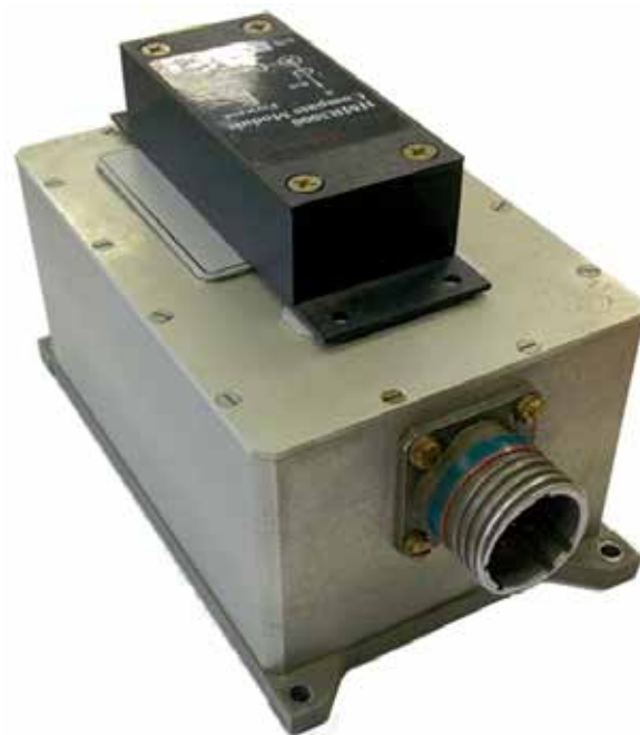
Рис. 4. Трехосный измеритель ИПДММ-1, укомплектованный цифровым магнитным компасом НМР3000
