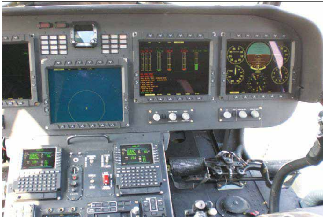
Рис. 1. Вид кабины с системой электронной индикации и многофункциональными пультами управления
