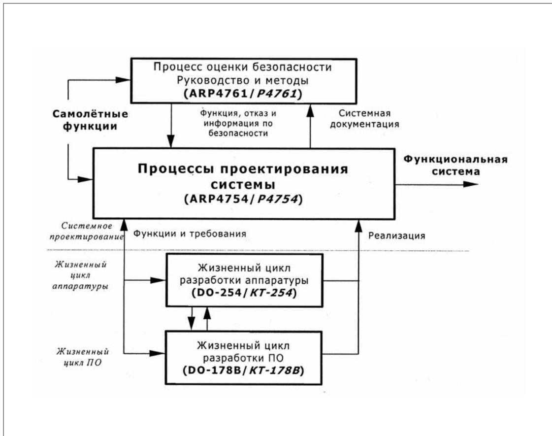
Рис.1 Руководство по сертификации в части процессов проектирования систем, аппаратуры, программного обеспечения (ПО) и оценки безопасности
