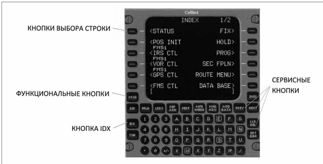
Рис. 1 Многофункциональный пульт управления и индикации
