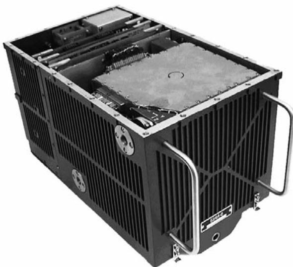
Рис.9. Моноблок системы БИМС-Т
