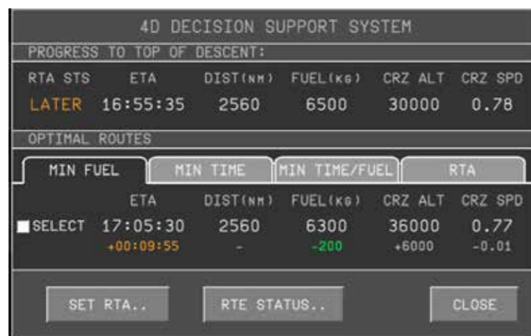
Рис. 7. Внешний вид ПО ЧМИ с информацией об оптимальном по критерию минимума расхода топлива
