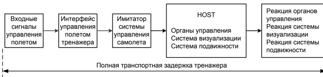
Рис. 3. Моделирование самолета с компьютерным управлением с использованием программной эмуляции оборудования самолета
