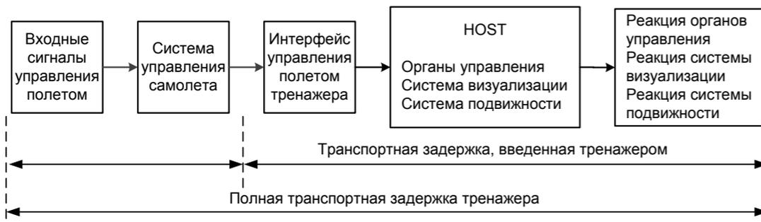
Рис. 2. Моделирование самолета с компьютерным управлением с использованием оборудования реального самолета
